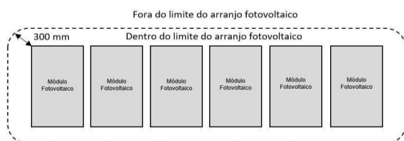
Figura 2 – Representação dos limites de um arranjo fotovoltaico
