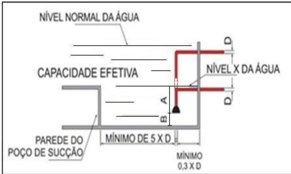
Figura 15: Tomada superior de sucção para bomba principal
