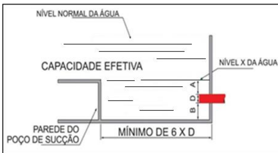
Figura 14: Tomada lateral de sucção para bomba principal
