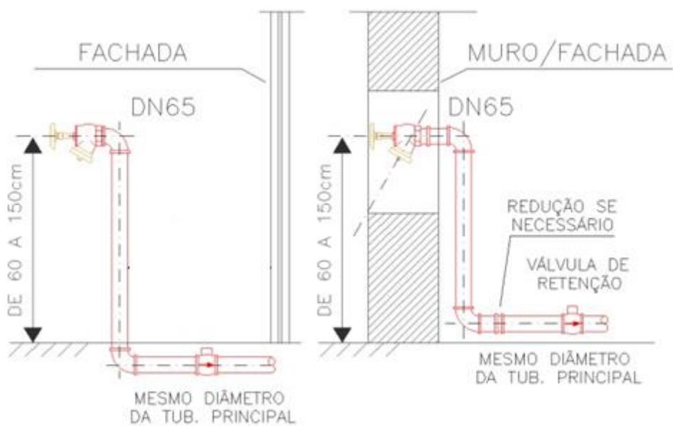
**Figura 4:** Dispositivo de recalque
