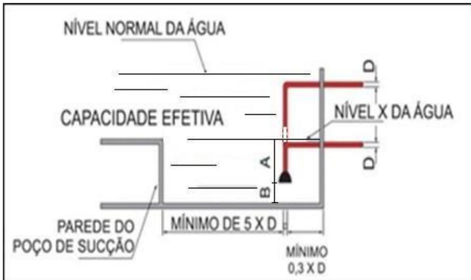
**Figura 15:** Tomada superior de sucção para bomba principal
