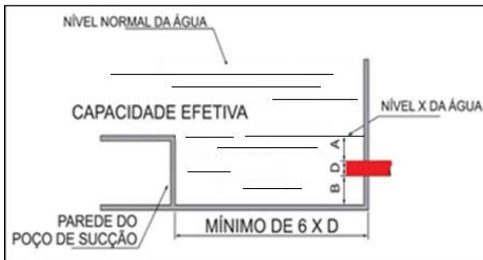
**Figura 14:** Tomada lateral de sucção para bomba principal
