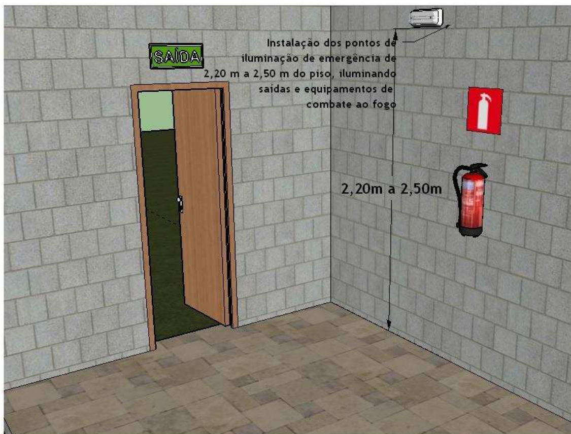
Figura 48 - Instalação dos pontos de iluminação de emergência
