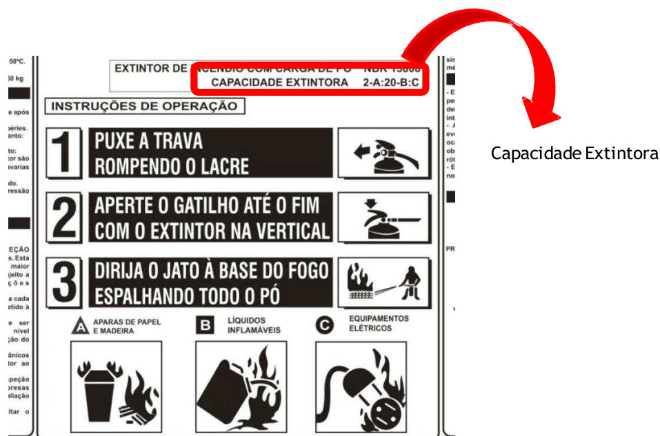
Figura 31 - Capacidade extintora no quadro de instruções (rótulo) do extintor
